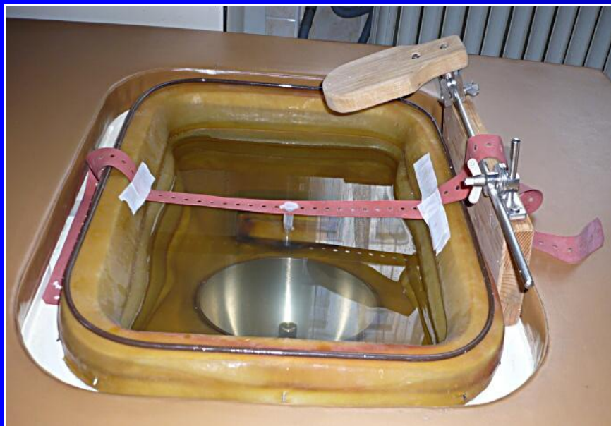
Umístění zkumavky pomocí speciálního držáku
